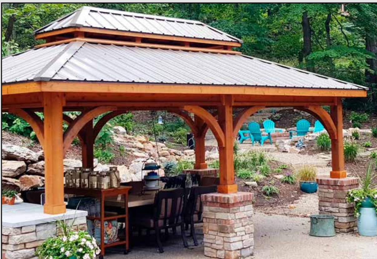
12'x20' · HD braces · metal roof · extended overhang · cedar sealer
